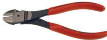
Kraftseitenschneider Knipex Spezial WS-Stahl, geschmiedet, gehärtet, Schneiden induktivgehärtet. Schenkel tauchisoliert, Kopf poliert
